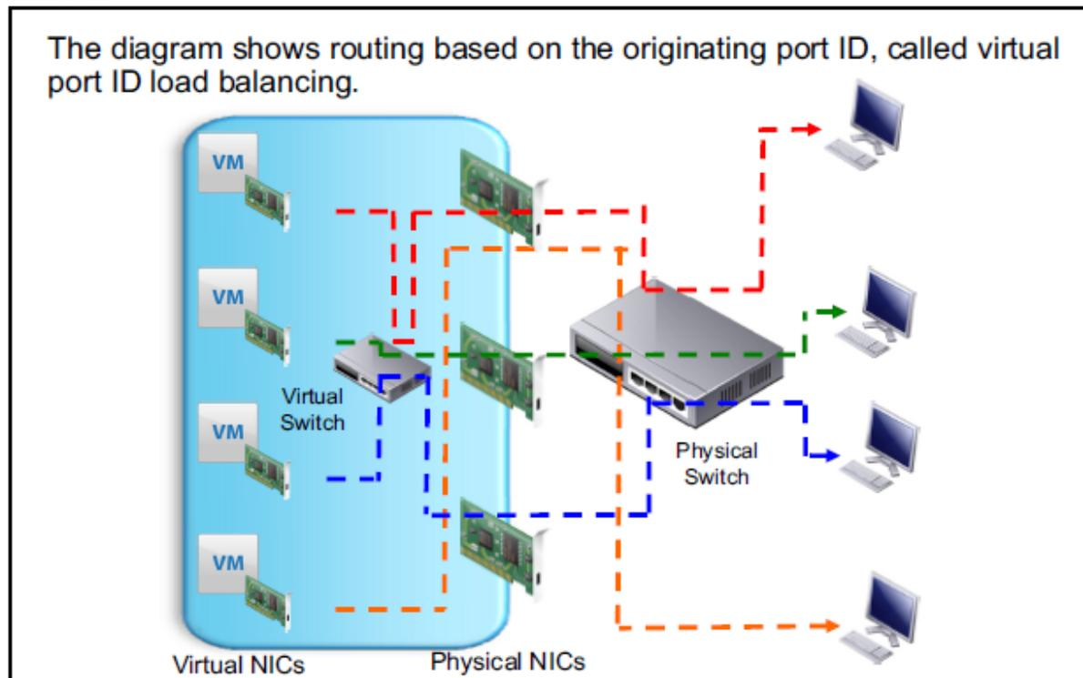
یکی از روش های Loadbalancing که می توان برای یک Port Group استفاده کرد و به صورت پیش فرض استفاده می شود Originating Virtual Port ID می باشد که براساس Virtual Port ID می باشد زمانی که یک ماشین مجازی به یک Port Group متصل می شود از Port Group یک Virtual Port ID می گیرد براساس VPID و نسبت به تعداد کارت های فیزیکی یک Port Group عملیات Round Robin برای تقسیم بار شبکه استفاده می شود. در این روش ترافیک یک ماشین مجازی همیشه از یک کارت شبکه فیزیکی ارسال یا دریافت می شود.
