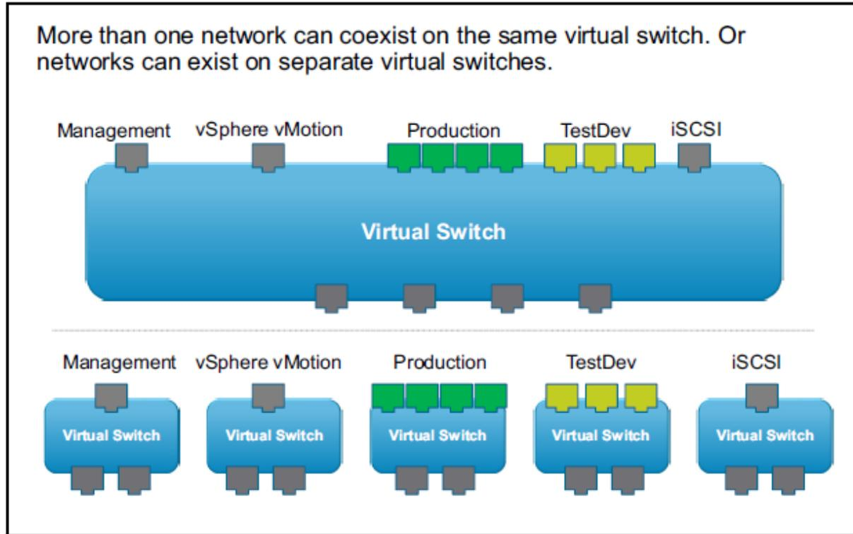
در پیکربندی و ایجاد vSwitch در صورتی که Uplink های سرور فیزیکی محدود باشد می توانیم از یک vSwitch استفاده کنیم و تمامی Uplink های سرور را به آن اختصاص دهیم و بر روی این vSwitch می توانیم چندین Port Group برای ماشین های مجازی و چندین VMkernel Port برای کارهای دیگری مانند Management و یا vMotion و یا iSCSI ایجاد کنیم.
