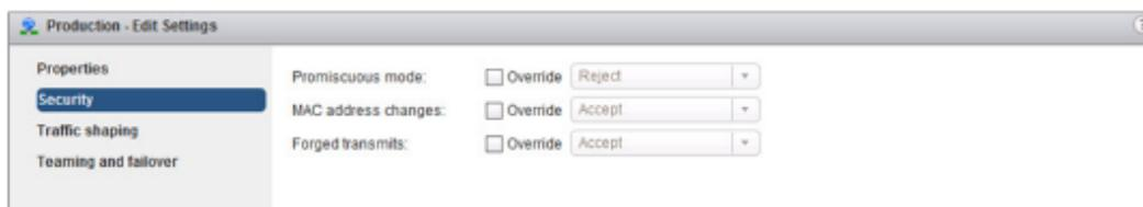
مدیر شبکه می تواند Security Policy ها را روی هر دو Standard Switch Level یا Port Group Level به صورت زیر انجام دهد:
