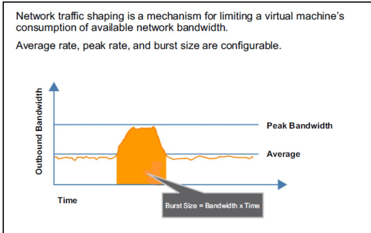
پهنای باند کارت شبکه یک ماشین مجازی میتواند توسط Network Traffic Shaper کنترل شود.
