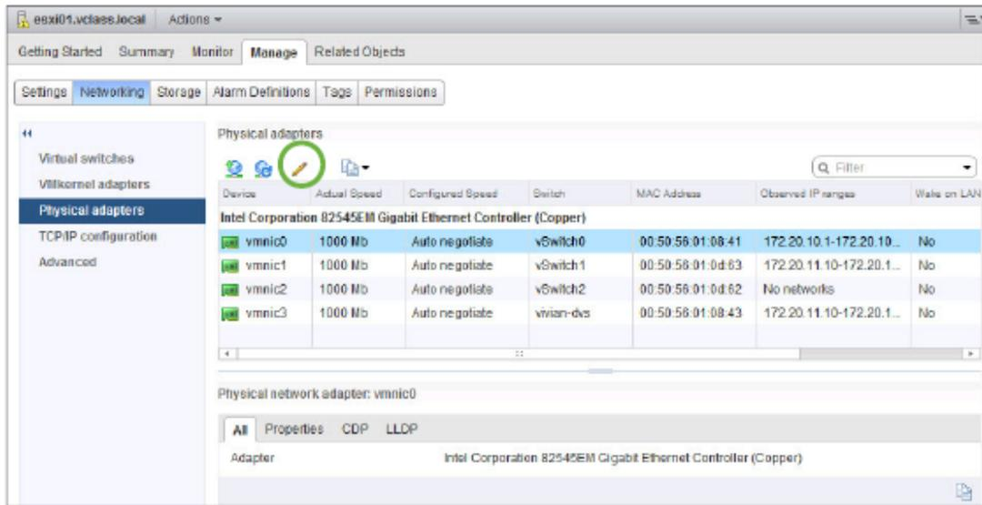
برای مشاهده کارت های شبکه فیزیکی یک سرور یا Physical Adapters می توانید بر روی Host کلیک کرده سپس وارد قسمت Manage شده و از این قسمت وارد قسمت Networking شوید سپس در این قسمت بر روی Physical Adapters کلیک کنید در این قسمت شما می توانید تمامی کارت های شبکه فیزیکی سرور را مشاهده کنید و در صورتی که بر روی یک کارت شبکه کلیک کنید و بر روی مداد کلیک کنید می توانید تنظیمات مربوط به کارت شبکه مربوطه را مشاهده و یا تنظیمات مربوط به آن را تغییر دهید.
